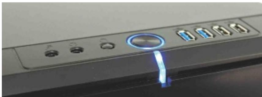
En el borde superior de la parte frontal disponemos de cuatro puertos USB (dos 3.0 y otros dos 2.0), que complementan al amplio elenco de conexiones traseras.
